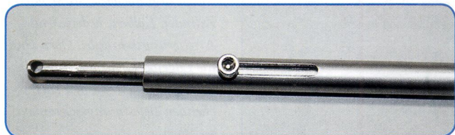
Der Kolben wird mit einer kurzen M3-Schraube im Führungslangloch arretiert. Er ist zur Montage im Lagerbock an der Rumpfseitenwand am oberen Ende mit einer 3-mm-Bohrung versehen.
