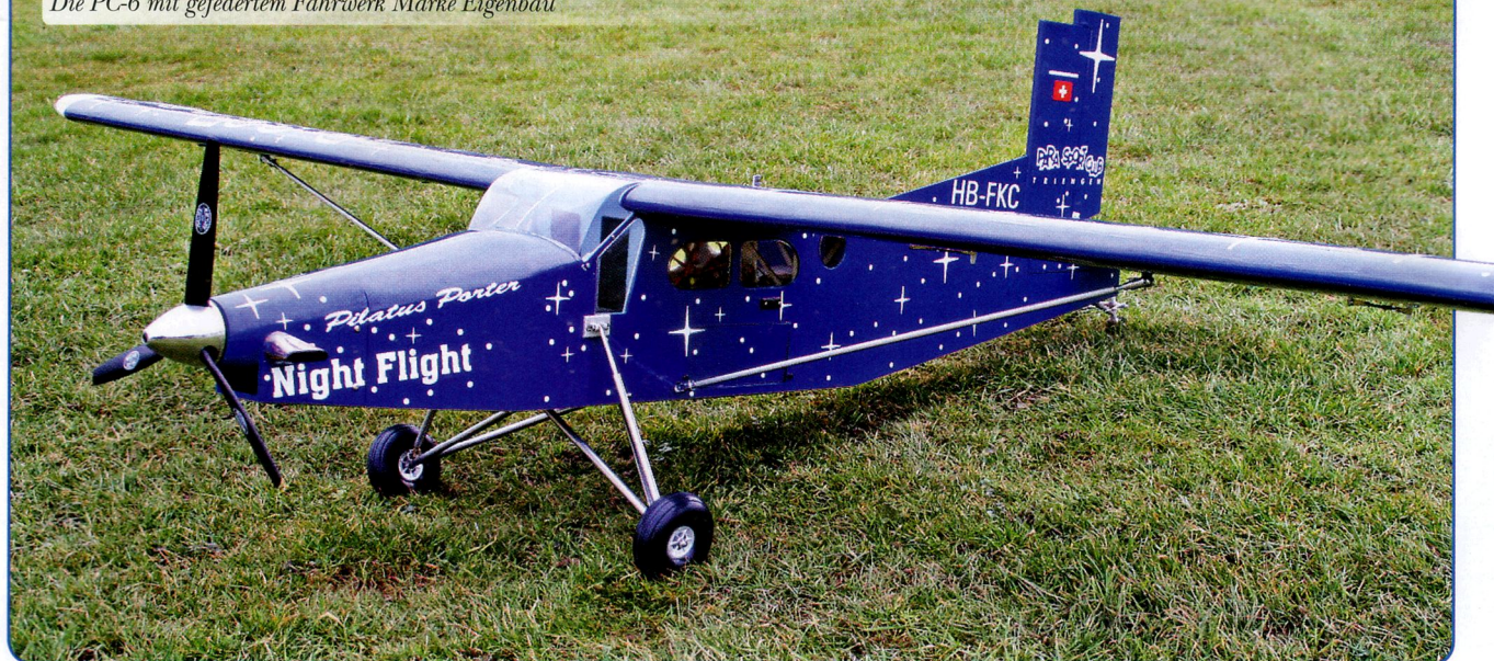
Die PC-6 mit gefedertem Fahrwerk Marke Eigenbau
